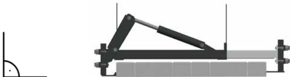
Abb. 16. Einstellung der Greifweite: senkrechte Stellung Greiferbacke
