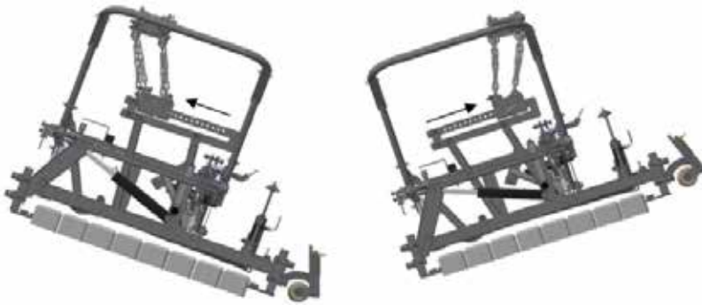
Abb. 67. Schräglagen des Greifers am Waagebalken
