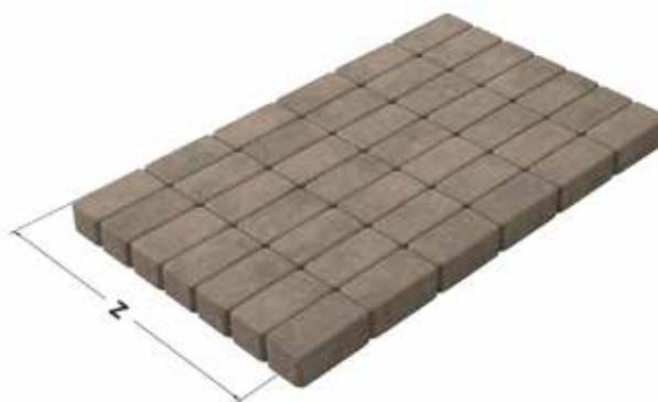
Abb. 13. Einstellung der Greifweite: Steinlage messen
